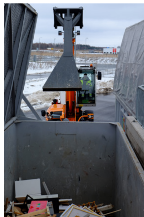
Med nivåskillnaden slipper man trängas bland bilar, släp och människor. Från den höjbara hytten har föraren perfekt sikt ner i containern, vilket underlättar arbetet när man t ex pressar ihop avfallet.
