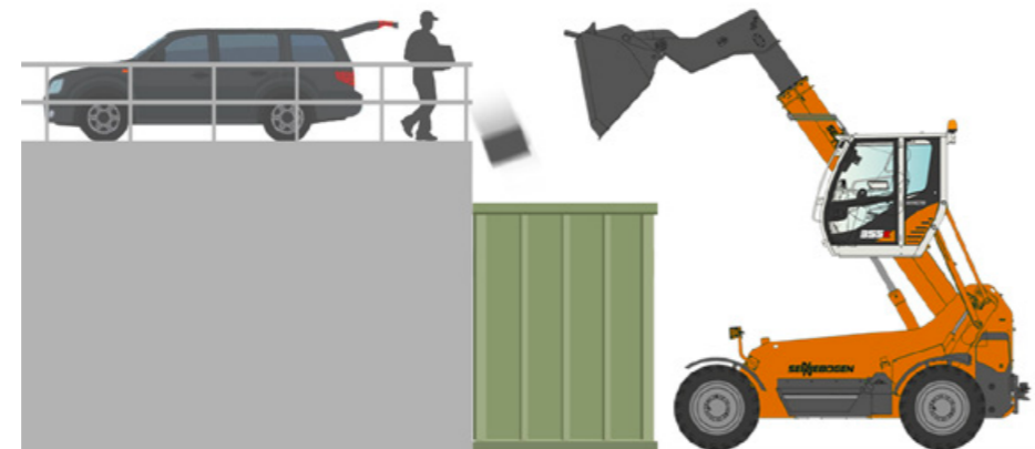
Med nivåskillnaden slipper man trängas bland bilar, släp och människor. Från den höjbara hytten har föraren perfekt sikt ner i containern, vilket underlättar arbetet när man t ex pressar ihop avfallet.
